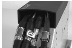
Schirmanschluss mit Clip und Metallkabelbinder
